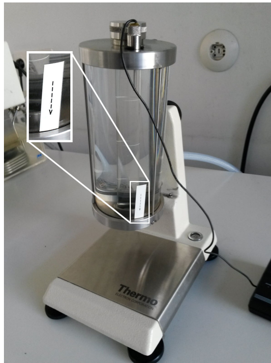
Abbildung 2: Korrekte Einstellung der Viskosimeter während sich Temperaturänderungen einstellen und außerhalb der Versuchsdurchführung, also auch beim Verlassen des Versuchsaufbaus.
