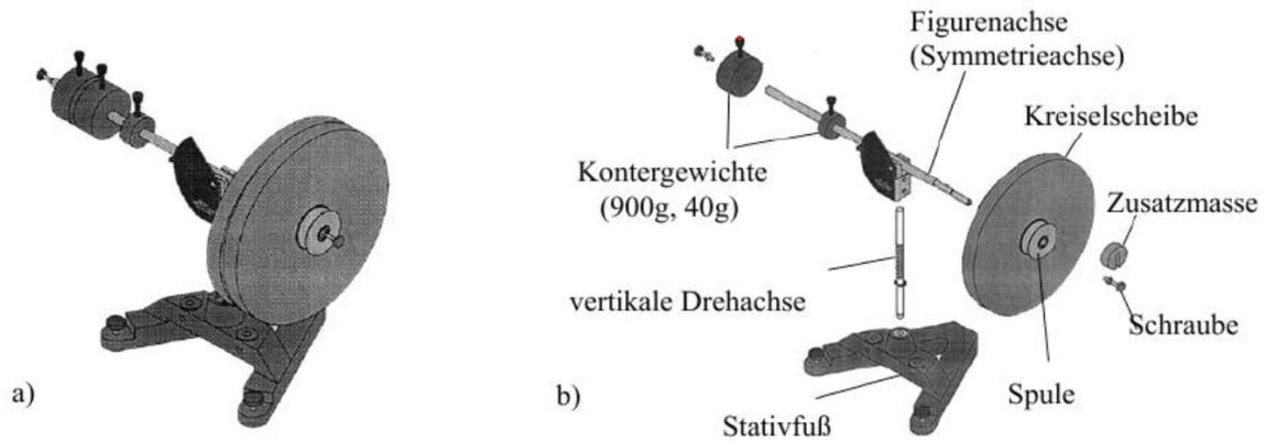
**Abbildung 3:** Das im Versuch verwendete Gyroskop ist unter a) illustriert. Unter b) sind die einzelnen Bauteile des Versuchsaufbaus sowie deren im folgenden verwendeten Bezeichnungen angegeben.
