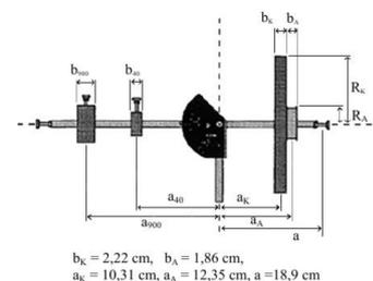
**Abbildung 7:** Abmessungen des Versuchsaufbaus
