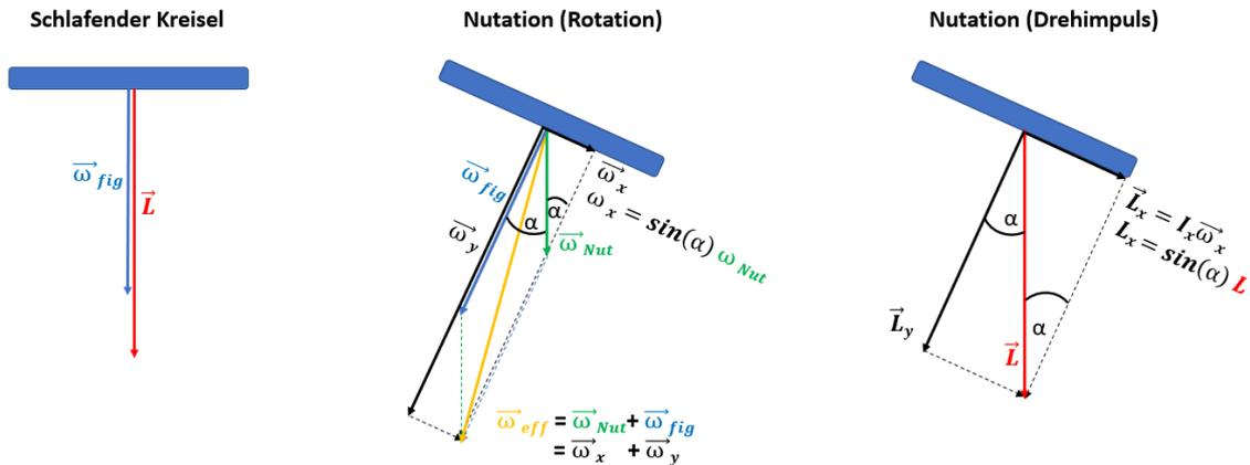
**Abbildung 1:** Vektorzerlegung der Winkelgeschwindigkeiten sowie der Drehimpulse im Fall der Nutation
