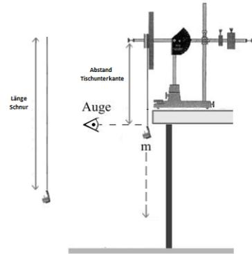
**Abbildung 6:** Beschleunigung der Kreiselscheibe
