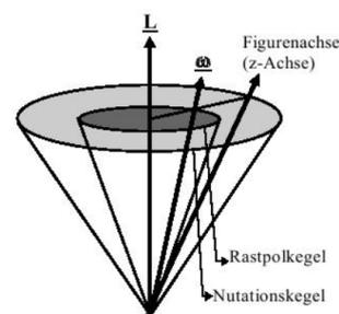
Die Winkelgeschwindigkeit  $\Omega_{Nut}$  lässt sich anschaulich anhand geschickter grafischer Vektorzerlegung gut bestimmen. Hierzu betrachte man Abbildung 1. Im Ausgangsfall befindet man sich im Fall des **schlafenden Kreisels** bei welchem der Drehimpulsvektor  $\vec{L}$  und
