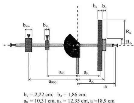
**Abbildung 9:** Abmessungen des Versuchsaufbaus
