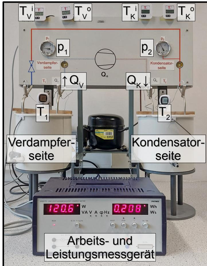
Abbildung 3.1: Foto des Versuchsaufbaus
