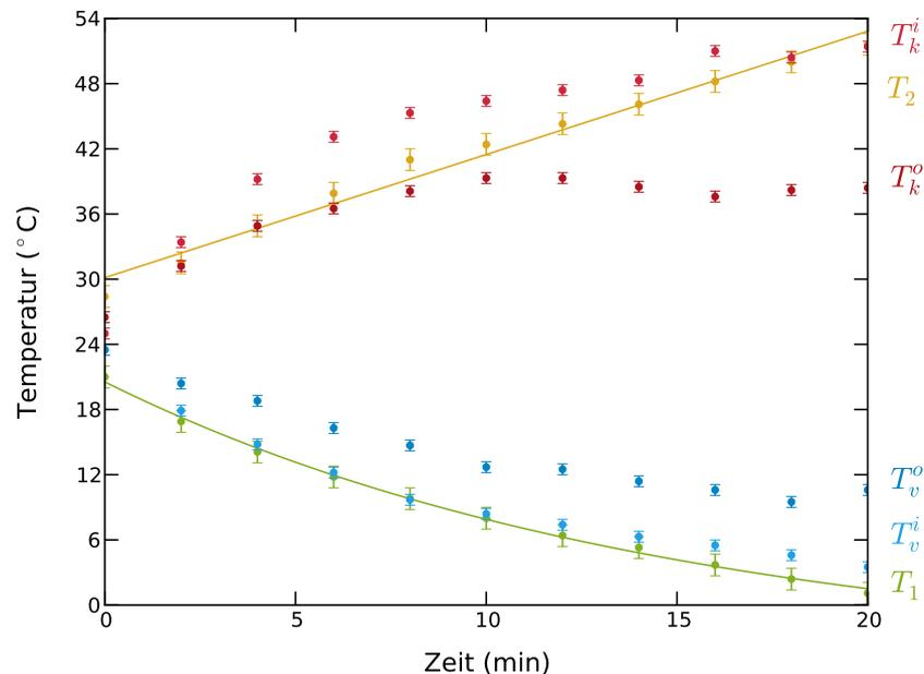
**Abbildung 6.1:** Temperaturen am Zufluss und Abfluss des Verdampfers ( $T_v^i$  und  $T_v^o$ ) und des Kondensators ( $T_k^i$  und  $T_k^o$ ) als Funktion der Zeit. Die durchgehenden Linien spiegeln den Temperaturverlauf in den Wasserreservoirs ( $T_1$  und  $T_2$ ) wieder. Im Idealfall sollte sich die Temperatur des Arbeitsmittels bei Verdampfung und Kondensation nicht ändern, sondern die benötigte bzw. frei werdende Energie von der Umgebung aufgenommen bzw. an diese abgegeben werden.
