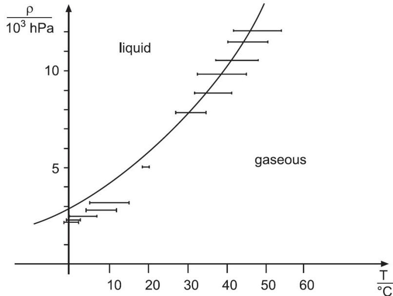
**Abbildung 6.3:** Zusammenhang zwischen (absolutem) Druck und Siedetemperatur des Arbeitsmittels. Die Enden der Fehlerbalken markieren die Temperaturen am Zufluss und Abfluss des Verdampfers bzw. Kondensators. Die durchgehende Kurve entspricht der Dampfdruckkurve, wie man sie aus den Messwerten in Tabelle 6.1 erhält. Quelle: PHYWE
