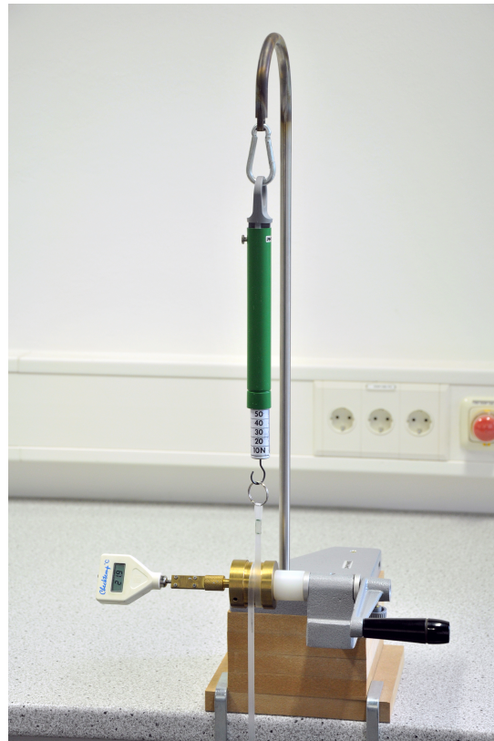
Abbildung 2: Kraftmesser, Zylinder mit Kurbel, Reibband und Thermometer. Nicht im Bild: 5 kg Gewicht
