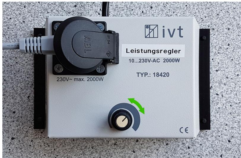
**Abbildung 5.1:** Foto des verwendeten Leistungsreglers. Der hier gezeigte grüne Doppelpfeil zeigt den Einstellbereich, welcher für ein leichtes Kochen des Wassers zu erwarten ist, ohne dass sprudelnd kochendes Wasser aus dem Behälter spritzt. Fangen Sie mit einer kleineren Leistung an und erhöhen Sie die Einstellung nur falls nötig.
