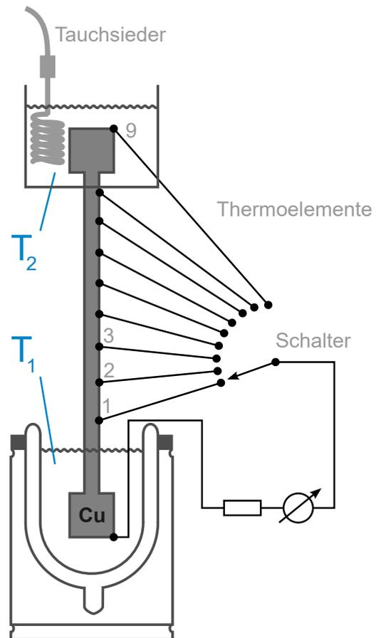
Abbildung 3.1: Skizze des Versuchsaufbaus.
