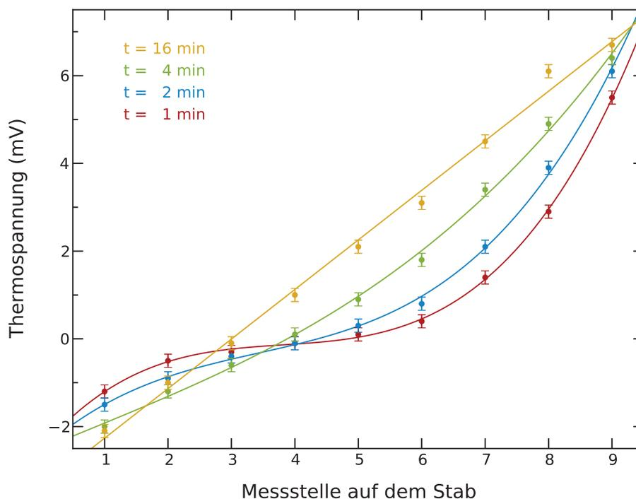
**Abbildung 6.3:** Temperaturverlauf im Stab zu verschiedenen Zeitpunkten  $t$ . Die Ausgleichskurven enthalten genau einen Wendepunkt und keine lokalen Maxima oder Minima. Für den stationären Zustand wurde eine rechnerische Geradenanpassung durchgeführt.
