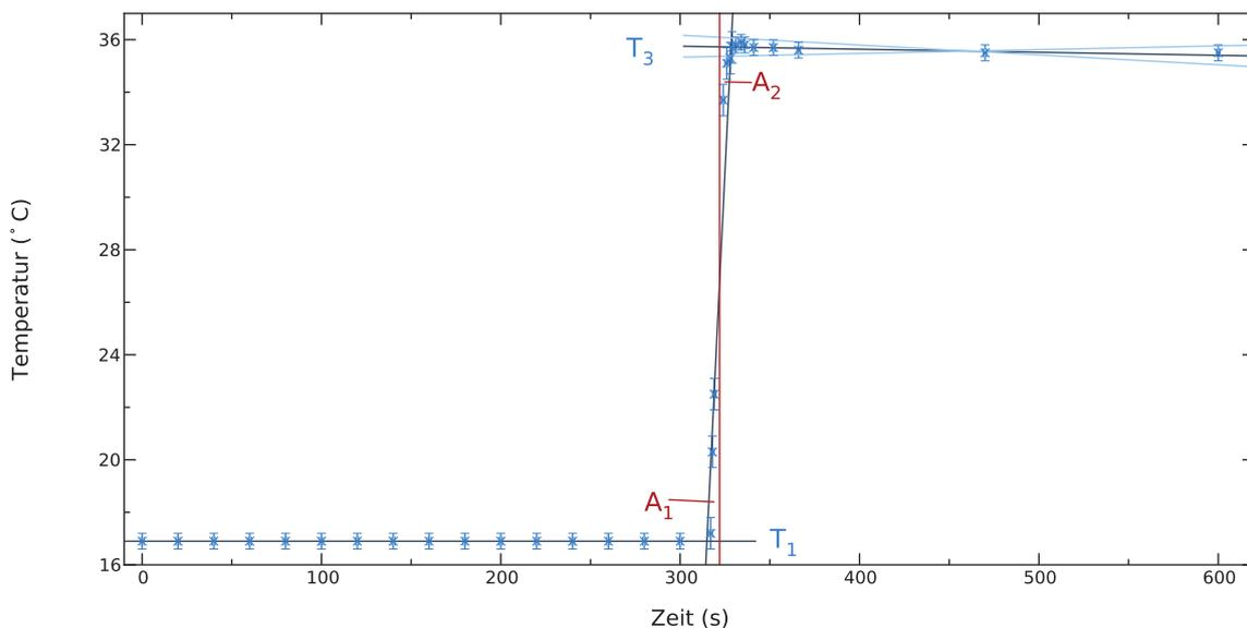
**Abbildung 6.1:** Schematische Darstellung eines Temperaturdiagramms mit grafischer Geradenanpassung zur Bestimmung der Mischungstemperatur. Beachten Sie, dass sich dieses Diagramm in mehrfacher Hinsicht von Ihrem unterscheidet. Unter anderem wurden hier nur für den dritten Abschnitt Extremalgeraden erstellt. Im ersten Abschnitt ist hingegen nur der konstante Verlauf nachvollzogen, es wurden hier also nicht die bei Ihnen benötigten Extremalgeraden erstellt.
