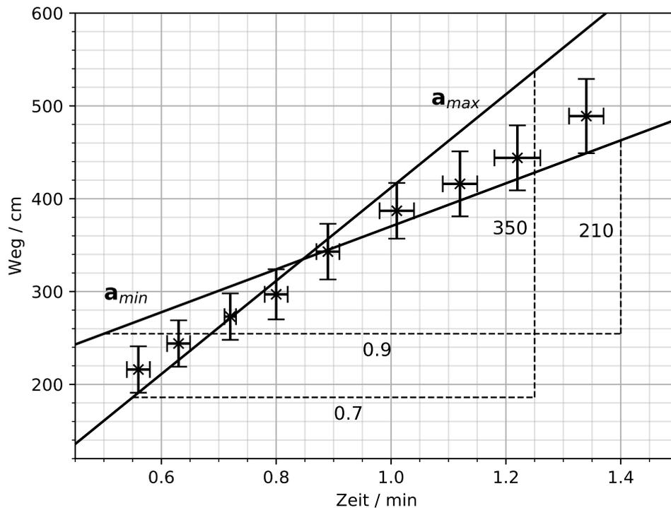
**Abbildung 8.1:** Vollständige grafische Geradenanpassung. Extremalgeraden und Steigungsdreiecke sind eingezeichnet und beschriftet. Dazugehörige Rechnungen befinden sich im Text.
