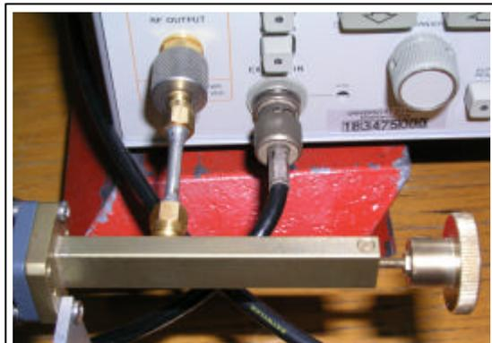
Abb. 4.15 : Koaxial-Hohlleiter-Adapter im Spektrometer, Übergang Generator nach Hohlleiter
