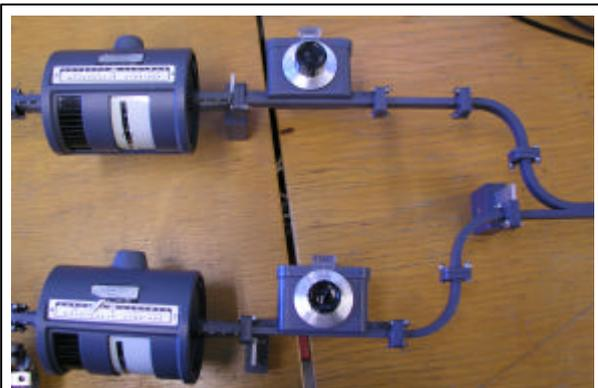
Abb. 4.5: Abschwächer und Phasenschieber zum Brückenabgleich
