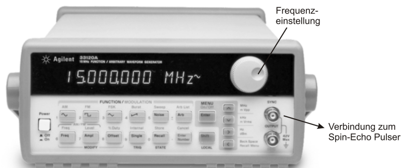
Abbildung 6: Übersicht über die Bedienungselemente des HF-Generators.
