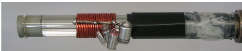
Abbildung 3: Sondenkopf bestehend aus einem Röhrchen gefüllt mit Glycerin, das von einer Spule und einem Kondensator umgeben ist. Spule und Kondensator bilden einen Schwingkreis.
